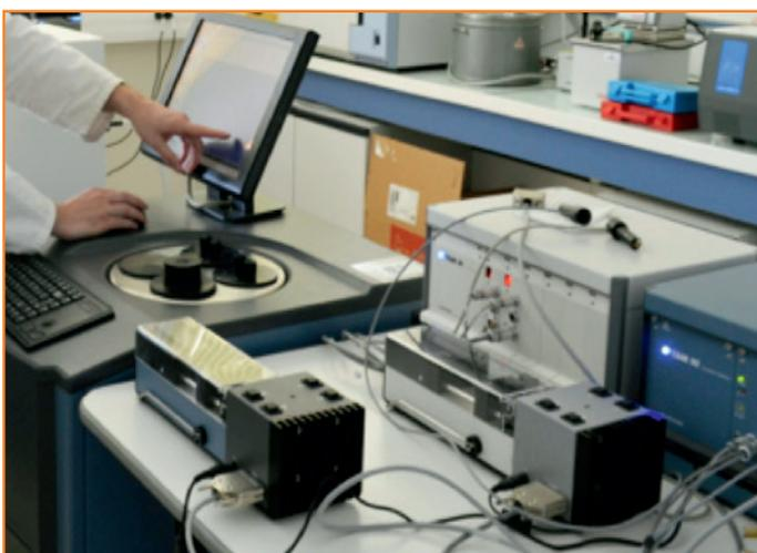
*Calorimètre de titration TAM III (TA Instruments)*
