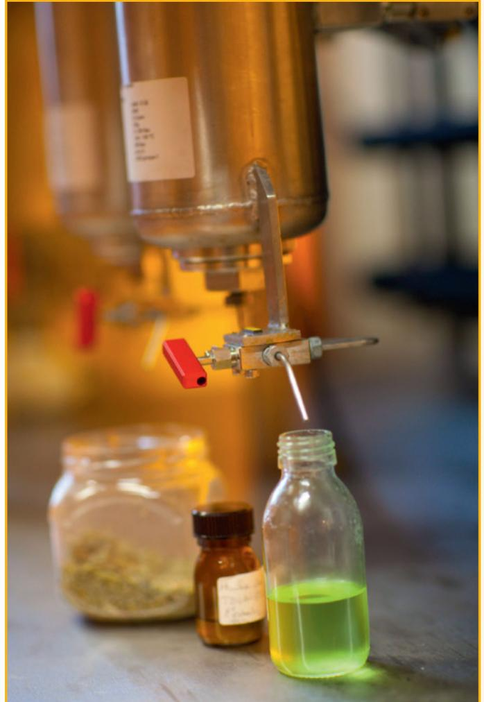
*Pilote d'extraction par CO<sub>2</sub> supercritique - Innovation Fluides Supercritiques.*
