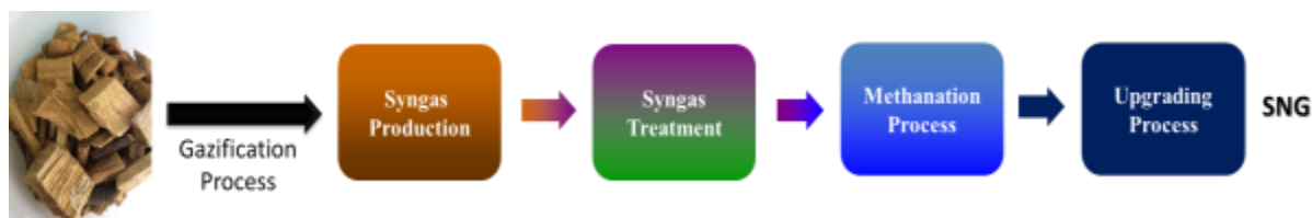
Figure 3.8 : Schéma de principe de la production de biométhane à partir de la biomasse
