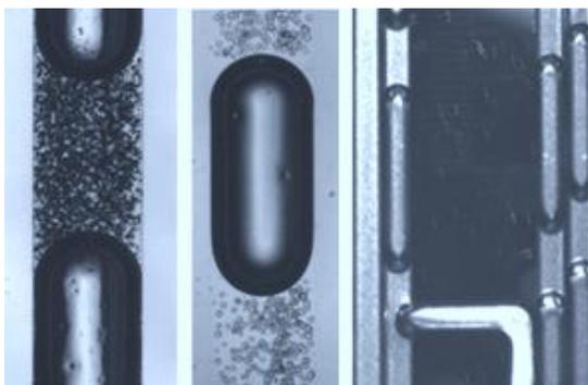
◀ Exemples d'écoulements multiphasiques dans des microréacteurs (canal cylindrique de 1,6 mm de diamètre (à gauche) et de section carrée 300 microns (à droite))
