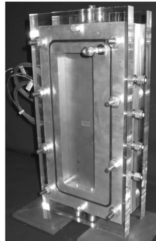
▲ *Plaque et réacteur prototype Mersen Boostec en carbure de silicium*
