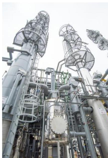
▲ Production d'acétate d'isopropyle utilisant une distillation réactive
