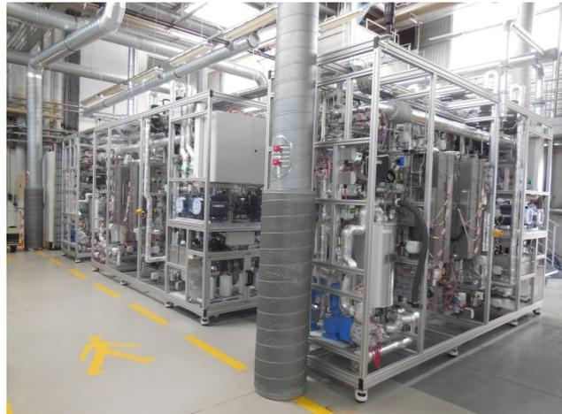
*Installation pilote à l'IFPEN avec plusieurs réacteurs en parallèle pour de l'acquisition de données procédés en haut débit ►*
