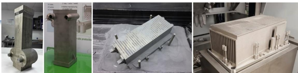
▲ Exemples de réacteurs produits par fabrication additive depuis 2014 : évolution des dimensions et des formes
